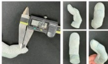
3D프린터를 활용한 손가락 보정기 출력물의 정확도 및 착용 모습
