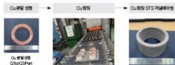
그림14. 한국생산기술연구원을 통해 개발된 Cu 용침 공정
